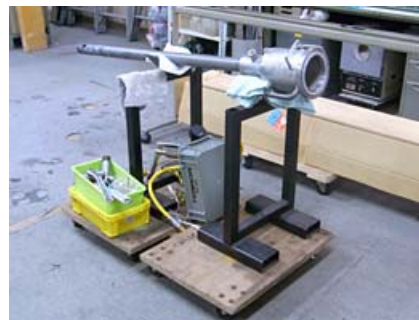
同社が取り扱っている監視カメラ。熱に耐えられるよう先端にカメラが取り付けられている
