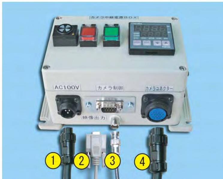
① 電源ケーブル AC100V 供給 付属 3 ピン 5 m。
